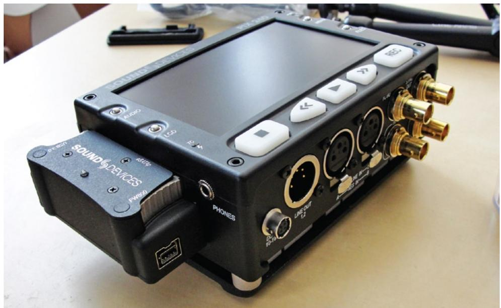
O adaptador PIX-Caddy serve para instalar directamente o disco SSD quando o ligamos ao computador para editar ou transferir o material captado. Mas quando o ligamos ao gravador PIX, podemos usar os interfaces FireWire ou USB 3.0 sem termos que retirá-lo...
